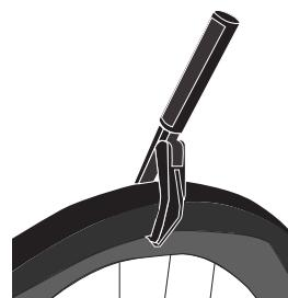
4. Potisnite bočnice pnevmatike v sredino in najnižji del obroča, da si zagotovite dodatni prostor pri nameščanju pnevmatike.
